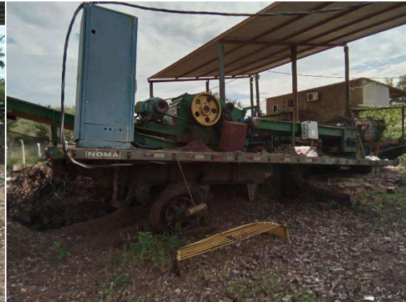
Picador/Triturador de Madeira (Poda de Árvore) inoperante. Necessidade de manutenção do motor (moto-redutor).
