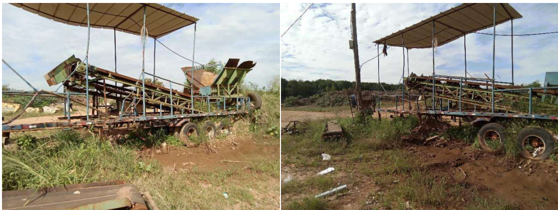
Visão lateral do equipamento de processamento de Resíduos de Construção Civil (RCC) e esteira de triagem inoperantes, cujo crescimento de vegetação indica tempo considerável na suspensão de seu uso.
